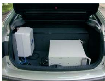
Figure 4 a) Enregistreur des paramètres de conduite b) Enregistreur vidéo
